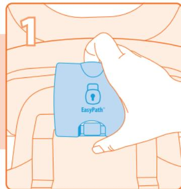
1. Trouvez le dispositif de verrouillage de la ceinture EasyPath™ et ouvrez la pince en tirant vers le bas puis vers le haut la languette supérieure.
