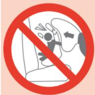
**NE PLACEZ JAMAIS CE DISPOSITIF DE RETENUE POUR ENFANT DOS À LA ROUTE SUR UN SIÈGE DU VÉHICULE DOTÉ D'UN AIRBAG FRONTAL ACTIF. LA MORT OU DES BLESSURES GRAVES PEUVENT SURVENIR.** Si un coussin gonflable se gonfle, il peut
