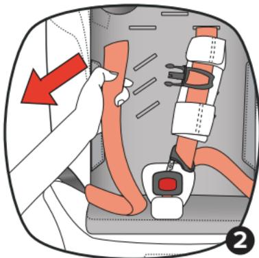
3. Con un destornillador estándar, ubique las muescas en el panel de acceso al arnés cerca de las guías inferiores del cinturón y separe el panel del armazón del asiento. Retire las correas viejas del arnés de cada lado del asiento.
