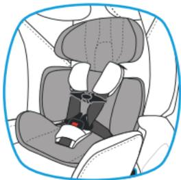
Para usar, deslice la hebilla a través de la ranura de la hebilla en el cojín para el cuerpo del bebé que coincida con la ranura elegida en el asiento y luego ajuste el arnés.
