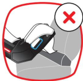
**NO empuje los pies de la base orientada hacia atrás en el asiento elevado, ya que esto cambiará el ángulo de inclinación.**
