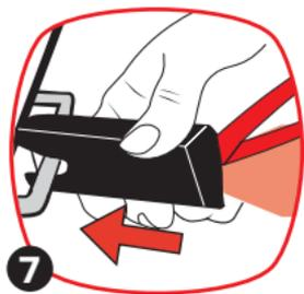
7. **Conecte los conectores LATCH/UAS a los anclajes LATCH/UAS del vehículo y escuche un "clic" audible para confirmar el acoplamiento.** La correa LATCH/UAS debe quedar plana y no torcida.
