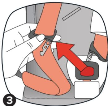
4. Vuelva a asegurar las correas del arnés a la placa de metal. Asegúrese de asegurar primero la correa izquierda en el gancho de metal y luego asegure la segunda correa en el gancho de metal.
