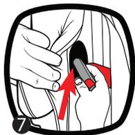
**7. Ubique la correa LATCH en el trayecto del cinturón orientado hacia el frente.** Pase la correa LATCH a través del trayecto del cinturón orientado hacia el frente (marcado con la etiqueta roja) y hacia fuera del otro lado. Los anclajes LATCH son más fáciles de atravesar tirando de la cubierta delantera hacia adelante como se muestra.
