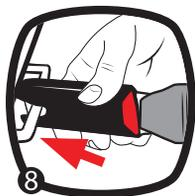
**8. Conecte los Conectores LATCH a los Anclajes LATCH Inferiores del Vehículo y escuche el clic para confirmar el enganche. La correa LATCH debe estar plana y no retorcerse.**
