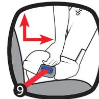
**10. Para quitar la correa LATCH del vehículo.** Presione los botones rojos de LATCH para conectarlos y retírelos de las barras de anclaje.
