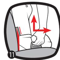
12. **Para quitar la correa LATCH del vehículo.** Presione los botones rojos de LATCH para conectarlos y retírelos de las barras de anclaje.
