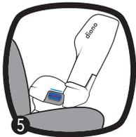
**5. Coloque el asiento para automóvil orientado hacia la parte trasera en el asiento trasero del vehículo.** Colóquelo orientado hacia la parte trasera, en el asiento del vehículo y centre el asiento para automóvil entre los anclajes LATCH inferiores. La base debe
