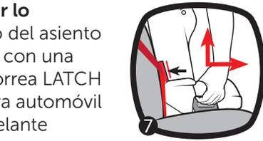
**7. Prueba para verificar lo ajustado.** Tome el lado del asiento en el lado de la hebilla con una mano donde está la correa LATCH y deslice el asiento para automóvil de lado a lado y de adelante hacia atrás. Si el asiento se mueve menos de 1 pulgada (2,5 cm), es lo suficientemente ajustado. No realice pruebas sujetando la parte superior del asiento.
