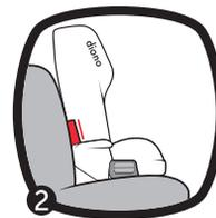
**3. Pase el cinturón de seguridad del vehículo.** Pase el cinturón de seguridad del vehículo por el trayecto del cinturón orientado hacia el frente (marcada con la etiqueta roja) y por el otro lado. Enganche y abroche. El cinturón de seguridad debe estar lo más plano posible y no estar retorcido.
