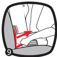
**9. Apriete la correa LATCH presione firmemente en el centro del asiento para automóvil mientras ajusta la correa LATCH.** Es posible que necesite ajustar a través de la abertura en la almohadilla en el trayecto del
