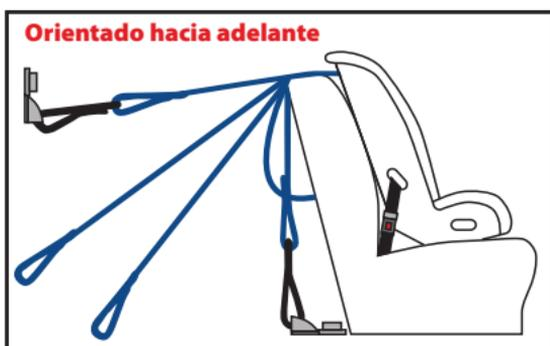
**Importante:** El diagrama muestra diferentes lugares donde puede estar el anclaje para la correa superior. Consulte el manual del vehículo para ubicar el anclaje adecuado.
